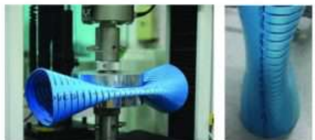
ภาพการทดสอบการทนแรงกด (Compressive Load) ของท่อเจาะร่องแนวขวาง
